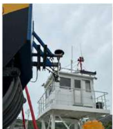
▲GNSSアンテナ
