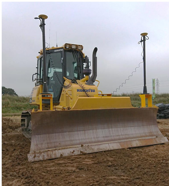
(排土板へのGNSSアンテナ設置状況)
