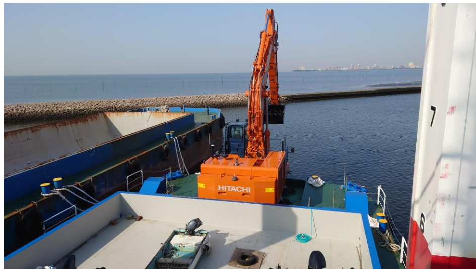
GNSSアンテナ設置例（カウンターウェイト）
