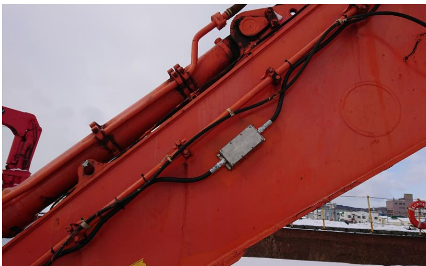
アーム用IMU設置例
