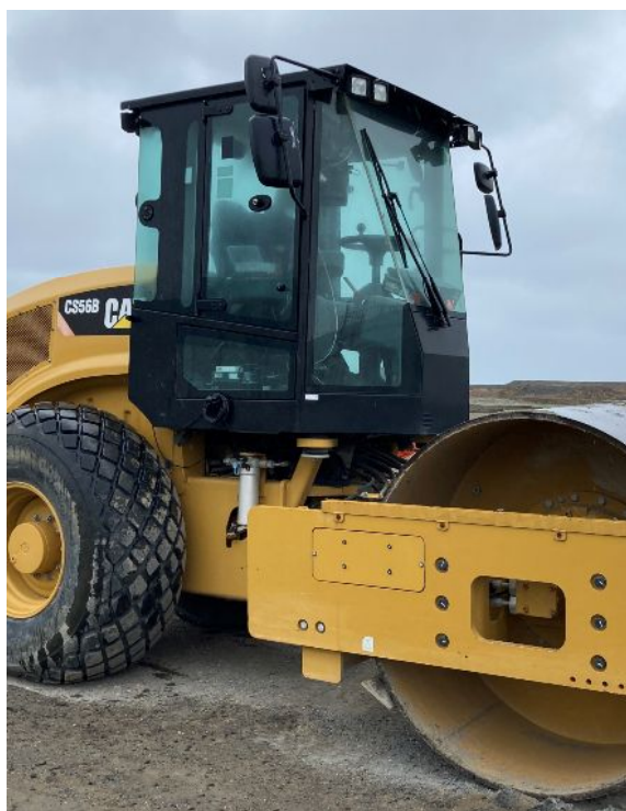
GNSSアンテナはキャビン上部に設置
